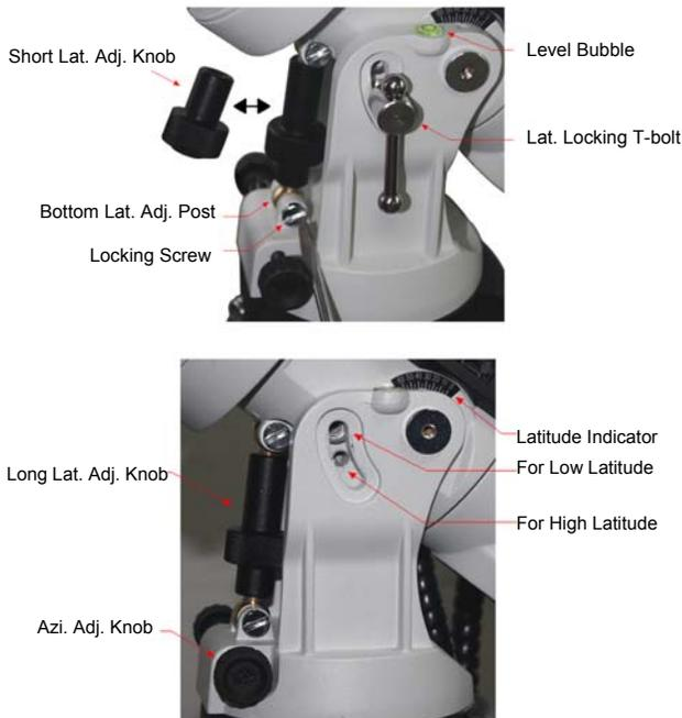
Figure 4. Switching latitude adjustment knobs
